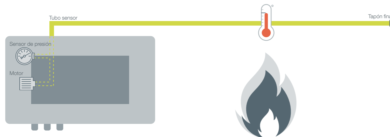
Principio de funcionamiento del ADW 535
